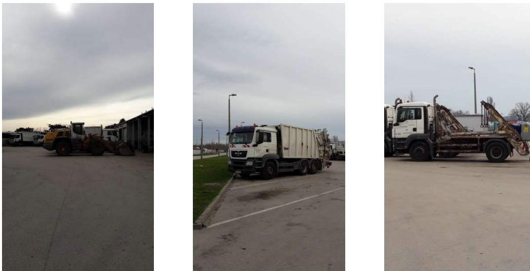
9. ábra: Homlokrakodó és hulladékszállító és darus konténer szállító, (Forrás: Saját fotó)
